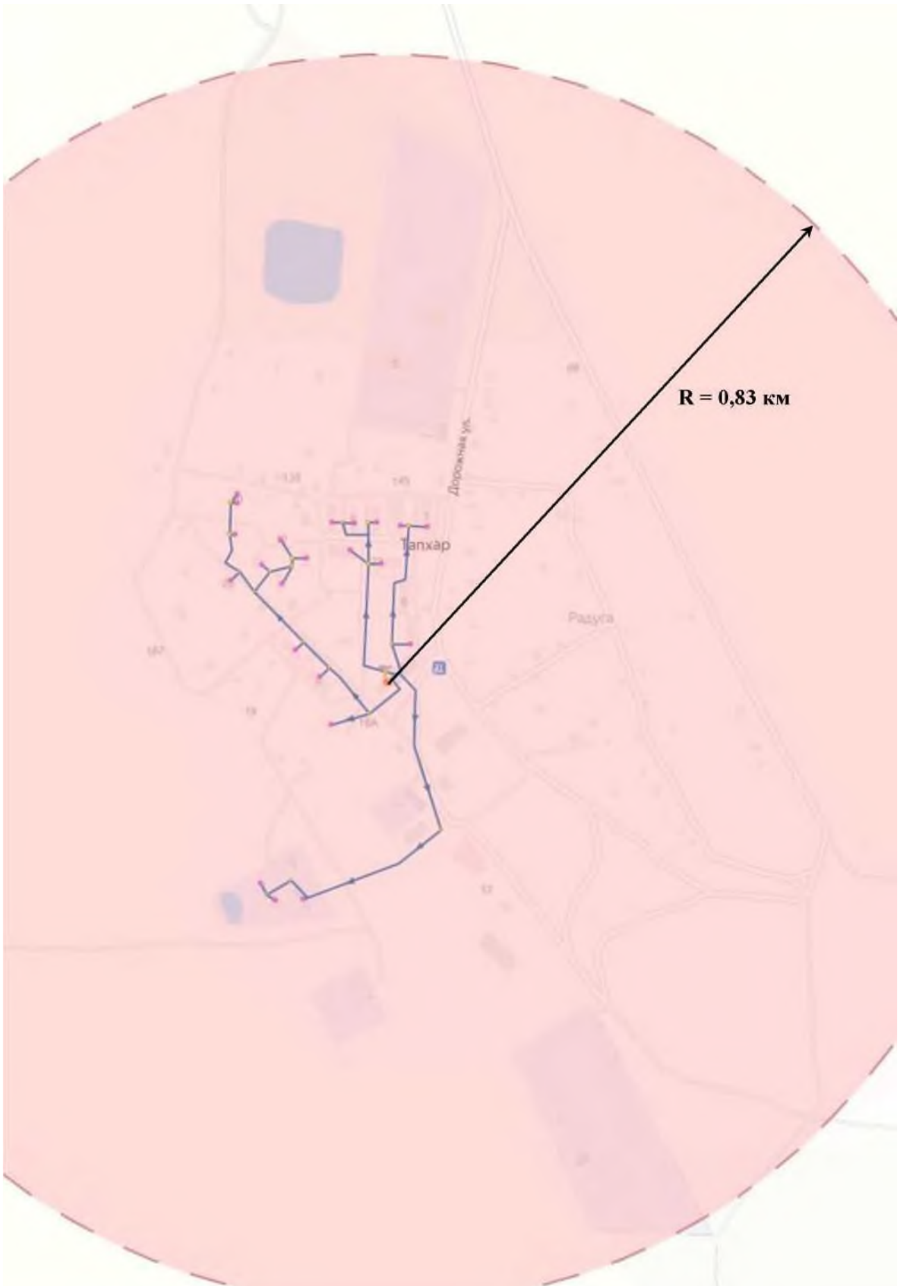
Рисунок 1. Радиус эффективного теплоснабжения котельной п. Тапхар.
