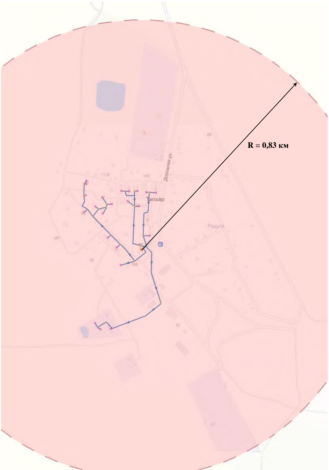
Рисунок 4. Радиус эффективного теплоснабжения котельной п. Тапхар.
