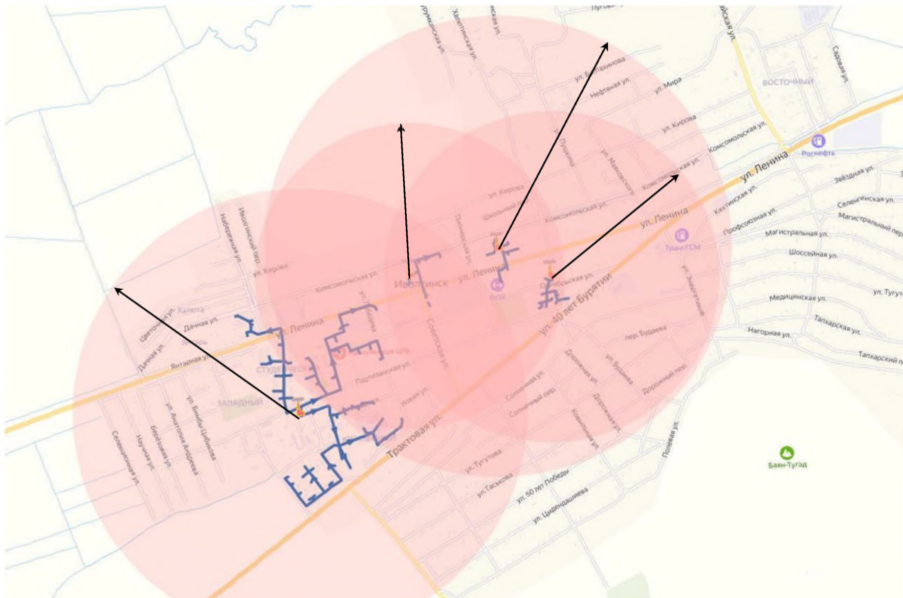
Рисунок 6. Радиусы эффективного теплоснабжения котельных с. Иволгинск.
