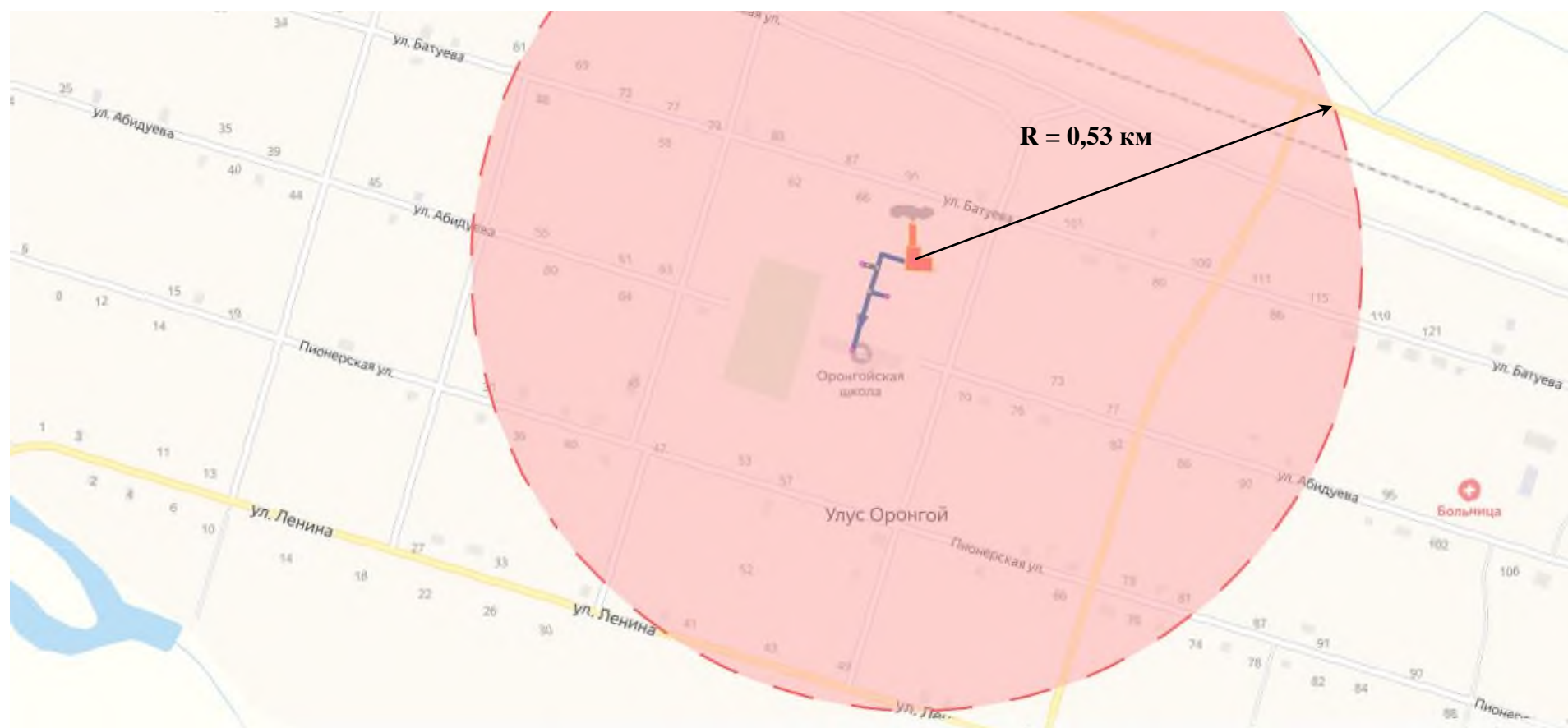
Рисунок 4. Радиус эффективного теплоснабжения котельной с. Оронгой.
