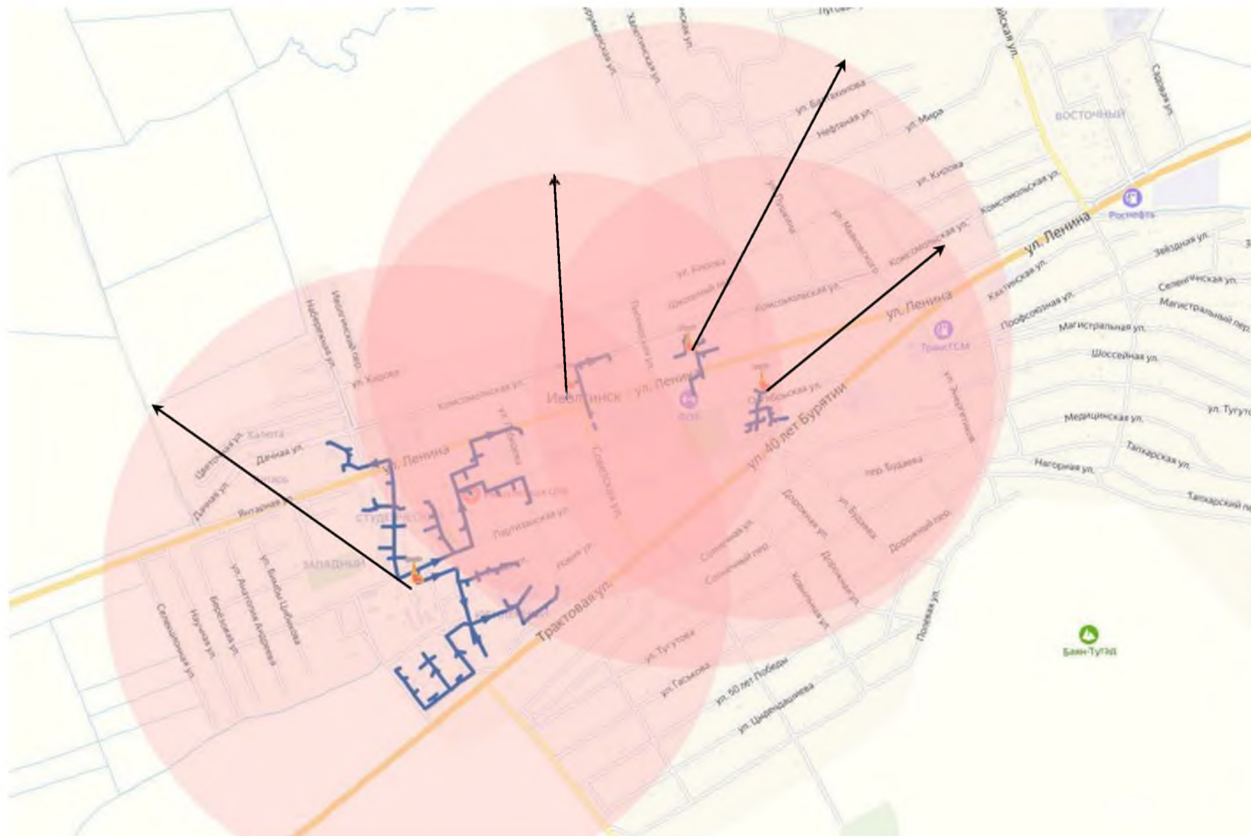
Рисунок 1. Радиусы эффективного теплоснабжения котельных с. Иволгинск.
