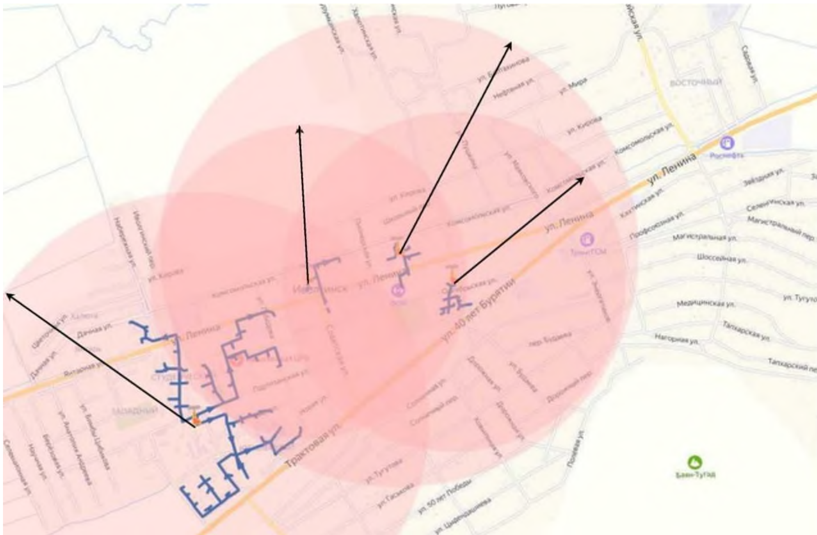
Рисунок 6. Радиусы эффективного теплоснабжения котельных с. Иволгинск.
