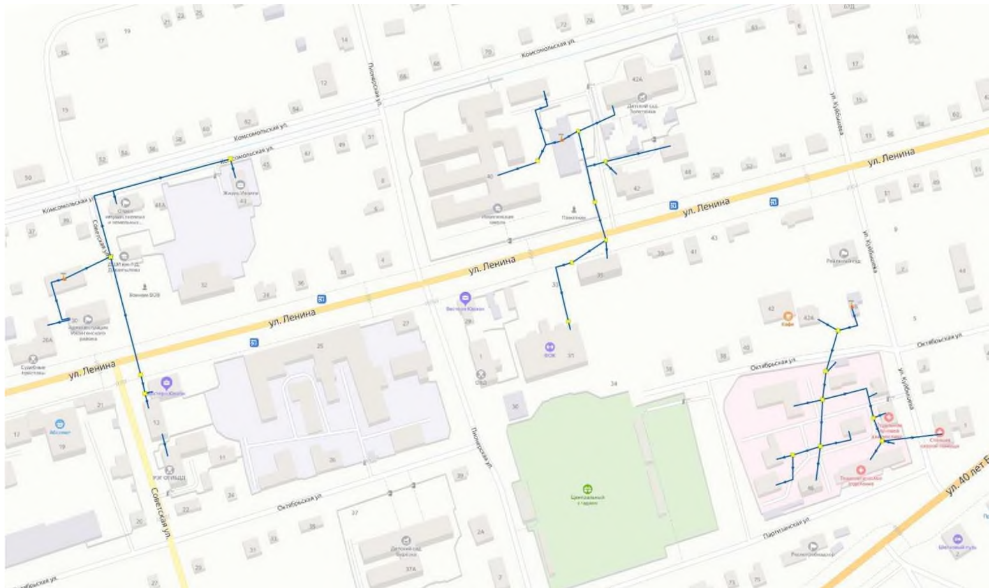
Рисунок 2. Графическая схема тепловых сетей котельных ИСШ, ЦРБ, АМСУ.
