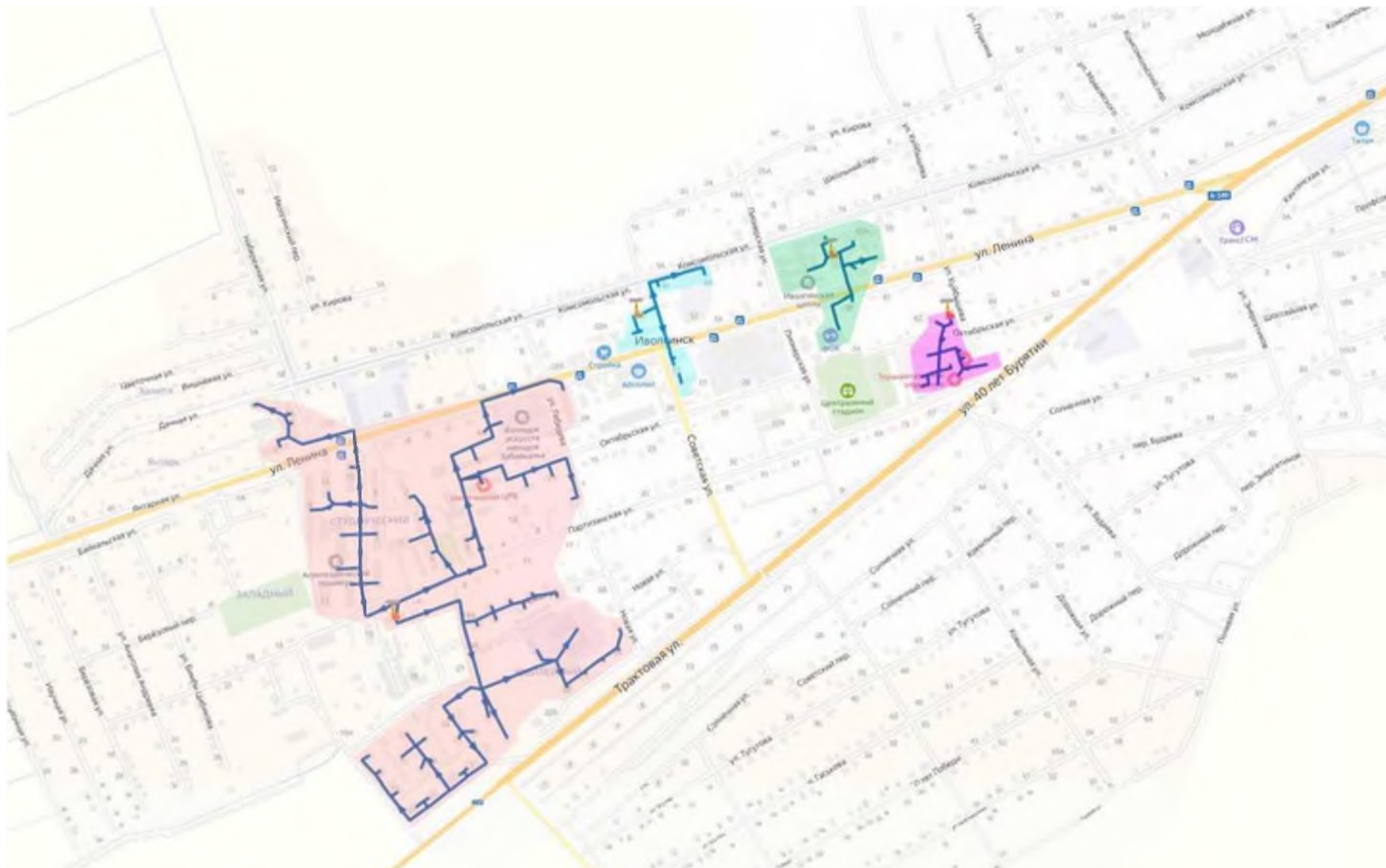
Рисунок 5. Зоны действия источников теплоснабжения с. Иволгинск.
