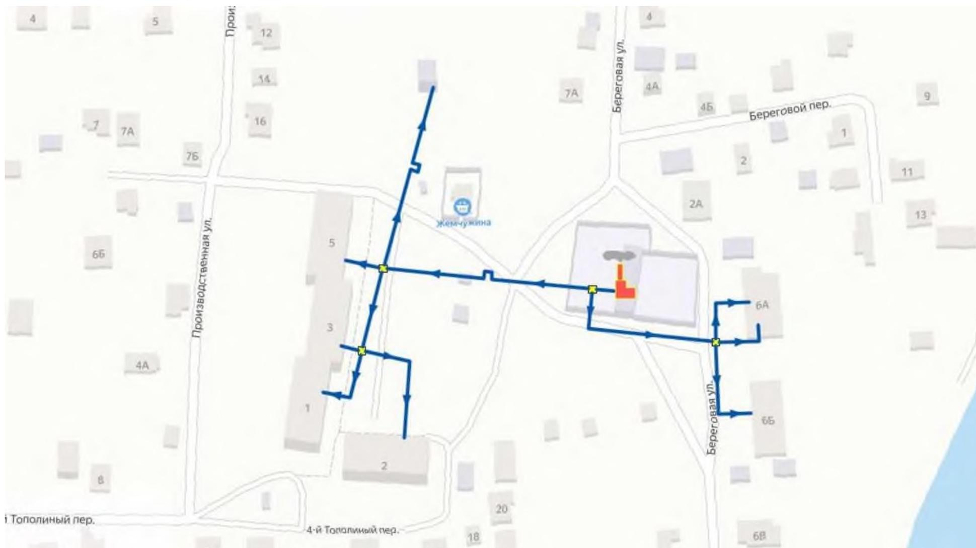
Рисунок 2. Графическая схема тепловых сетей котельной Береговая.
