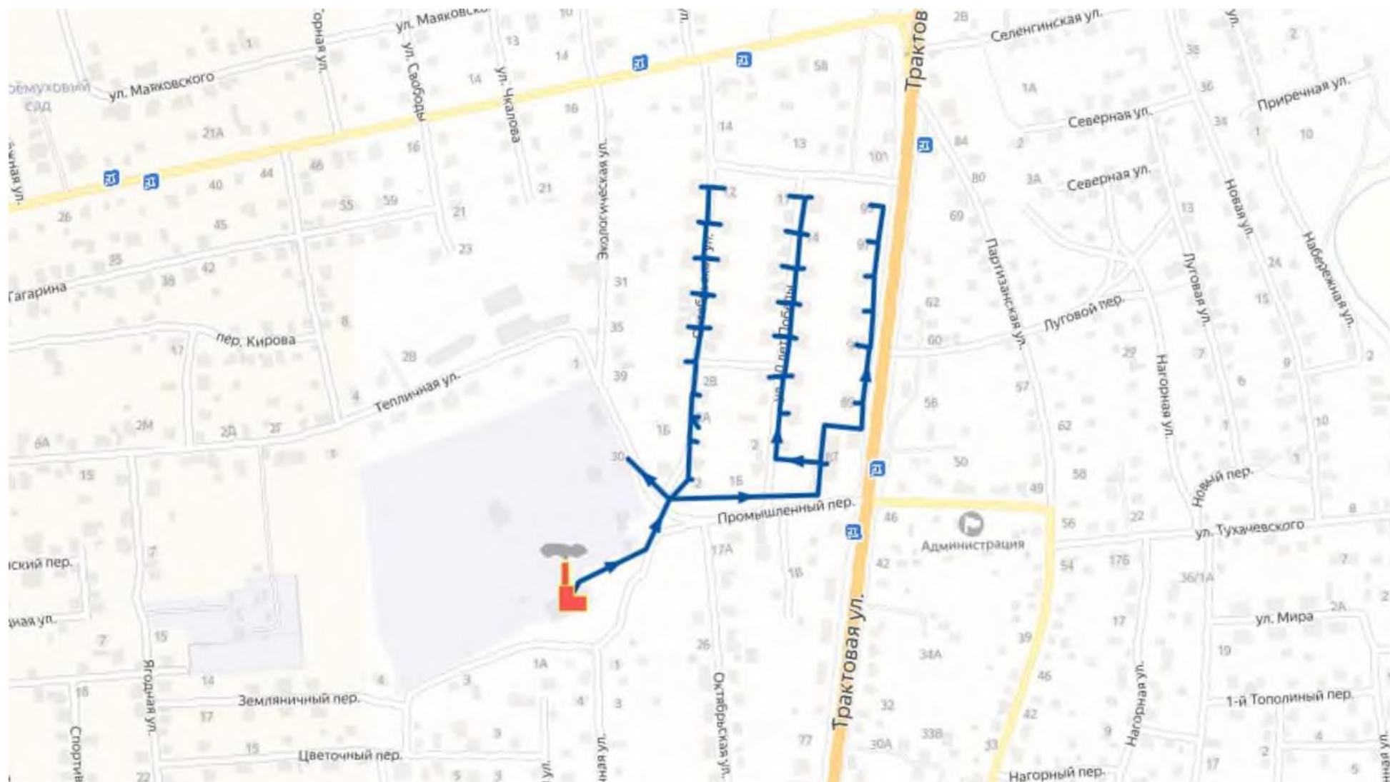
Рисунок 2. Графическая схема тепловых сетей котельной Пригородная.
