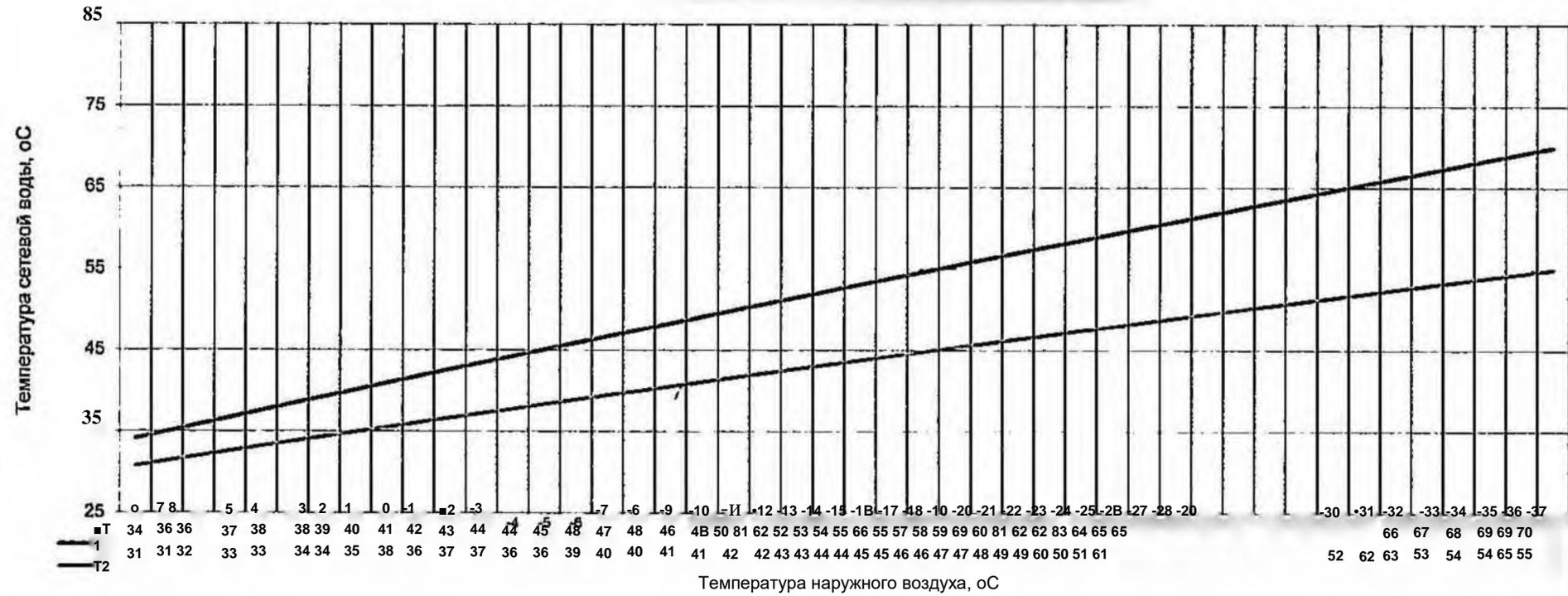
Примечание: Температура воды в подающей линии задается в зависимости от температуры наружного воздуха на промежуток времени 12 ч.
